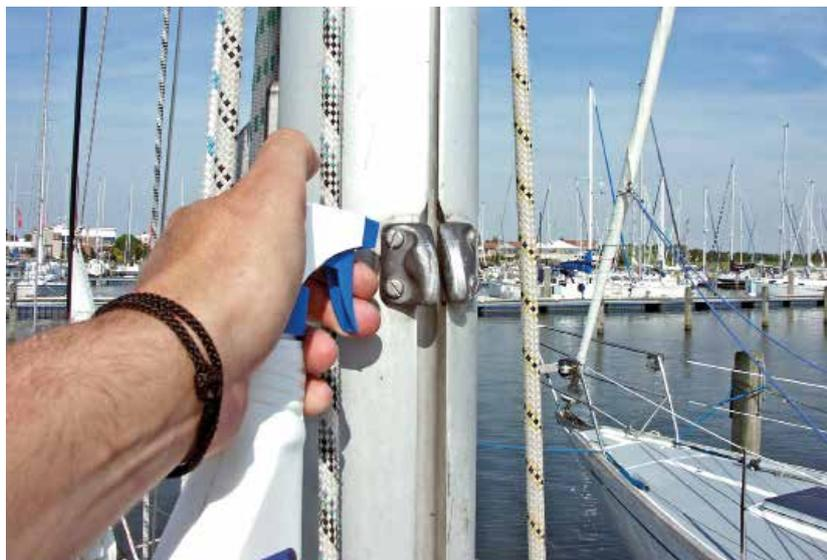
**Die Nuten in Mast und Vorstag wurden vor dem Mastsetzen behandelt, während der Saison reichte es, den von Deck zugänglichen Bereich einzusprühen, mit dem Setzen der Segel wurde das Mittel verteilt.**
